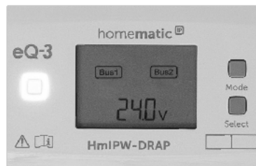
Display-Darstellung im Wired Access Point für die Auswahl „Zwei getrennte Busstränge“.
