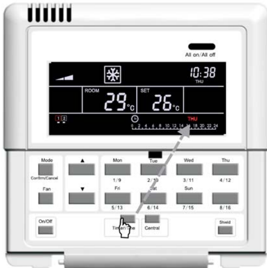
Während des individuellen Bedienungsmodus die Timer/Time-Taste drücken, um zum Timer-Einstellmodus zu wechseln.
