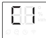
Wenn die Klimaanlage ausgeschaltet ist, startet die automatische Reinigung sofort. Wenn die Klimaanlage eingeschaltet ist, startet die automatische Reinigung, sobald die Klimaanlage ausgeschaltet wird.
