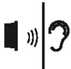
Wechselrichter kann im Betrieb Geräusche verursachen. Wechselrichter so montieren, dass Menschen durch die Betriebsgeräusche nicht gestört werden können.
