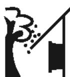
Wechselrichter vor herabfallenden Teilen schützen, die in die Lüftungsöffnungen des Wechselrichters gelangen können.
