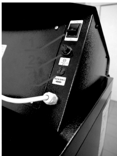
Bild 17. 1 – Hauptschalter, 2 – Havarie Thermostat, 3 – Sicherung (F6,3A)
