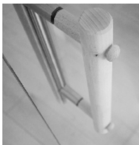
Silikonring in Bohrungen einlegen
