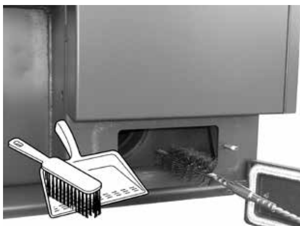
Muster – die Reinigung des Rauchkanals – unterer Deckel
