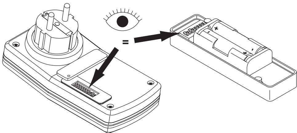
Die Codierung bei Funksender und Funkempfänger muss identisch sein. Falls zusätzlich noch ein BL220DD verbaut ist, bitte die Einstellung der Codierung entsprechend der Bedienungsanleitung anpassen.
