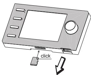
Gerät ist wieder voll funktionsfähig. Die Micro SD Card kann entfernt und später wiederverwendet werden.
