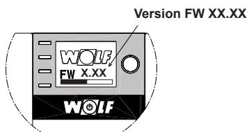
Die Software wird geladen und der Softwarestand angezeigt. Das BM-2 startet nach Beendigung des Updates automatisch neu.
