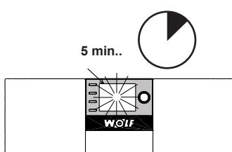
Das Display blinkt für ca. 5 Minuten oder ein roter Ladebalken zeigt den Update Fortschritt an – bitte während des Updates nicht aus dem Sockel ziehen, dies kann zur Beschädigung des BM-2 führen.
