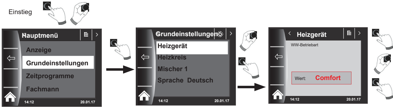
Abb. 9.1 Beispiel Warmwasser Betriebsart
