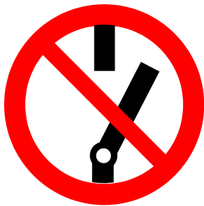
Abb. 3: Beispiel für ein Warnschild zum Sichern gegen Wiedereinschalten
